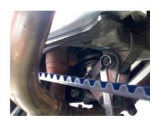
8 – **Ajustes finais**: certifique que o sistema montado todos os parafusos e porcas estejam bem apertados, limpe todos os resíduos de óleo/graxa, e verifique acessórios opcionais (capa de proteção inferior);
